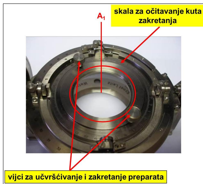
Slika 1.3. Shematski prikaz položaja osi A_1 na univerzalnom stoliću.
