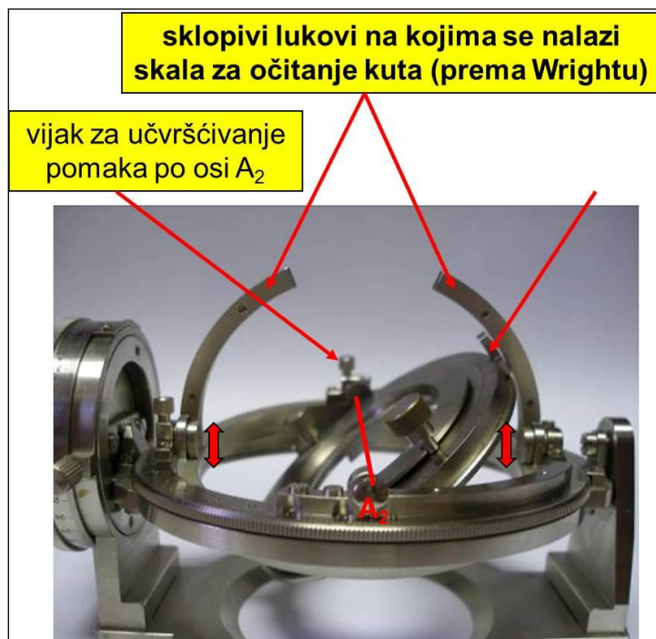
Slika 1.5. Shematski prikaz položaja osi A_2 na univerzalnom stoliću te Wrightovi sklopivi lukovi za očitavanje nagiba po istoj osi.
