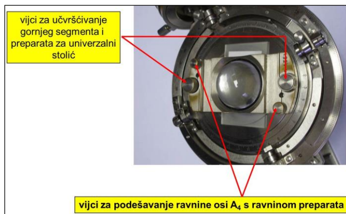
Slika 1.9. Pogled odozgo na gornji polukuglasti segment pričvršćen za univerzalni stolić (preparat se nalazi ispod), s označenim vijcima za učvršćivanje i vijcima za podešavanje.
