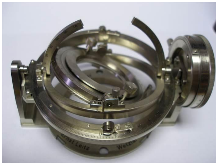
Slika 1.1. Univerzalni mikroskopski stolić prije ugradnje na polarizacijski mikroskop.
