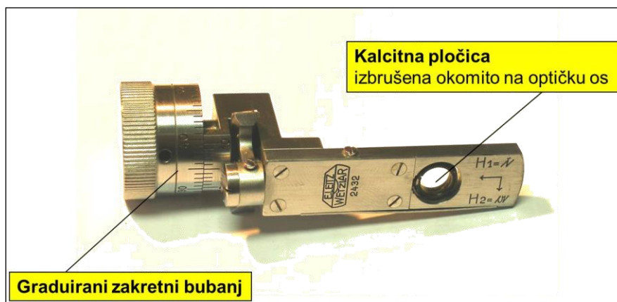
Slika 3.2. Konstrukcija Berekovog nagibnog kompenzatora
