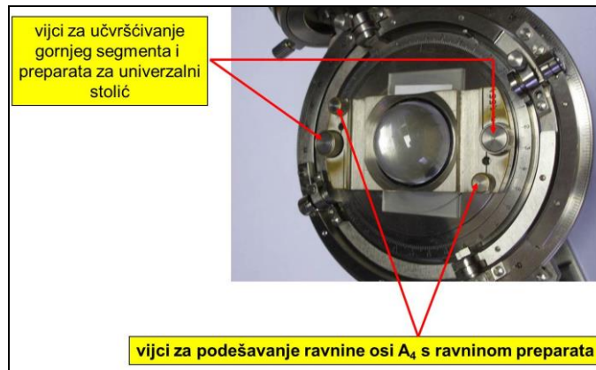
Slika 1.9. Pogled odozgo na gornji polukuglasti segment pričvršćen za univerzalni stolić (preparat ispod), s označenim vijcima za učvrščivanje i vijcima za podešavanje.
