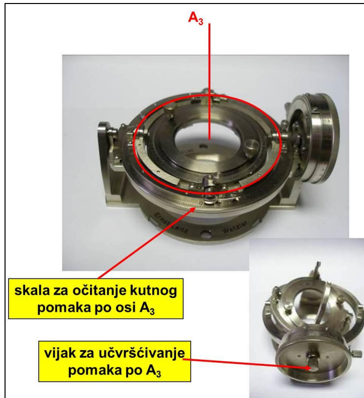
Slika 1.4. Shematski prikaz položaja osi A_3 na univerzalnom stoliću.
