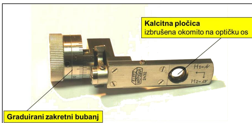
Slika 3.2. Konstrukcija Berekovog nagibnog kompenzatora
