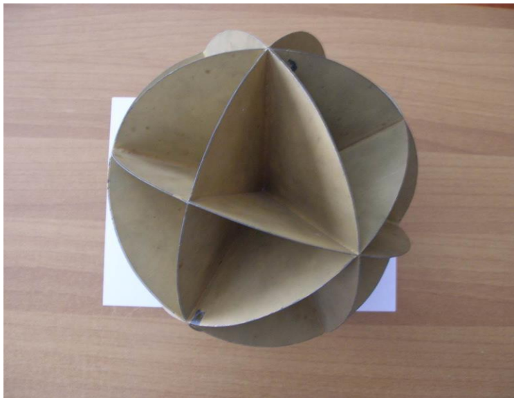
Slika 1.4. Optička indikatrixa izotropnih minerala.
