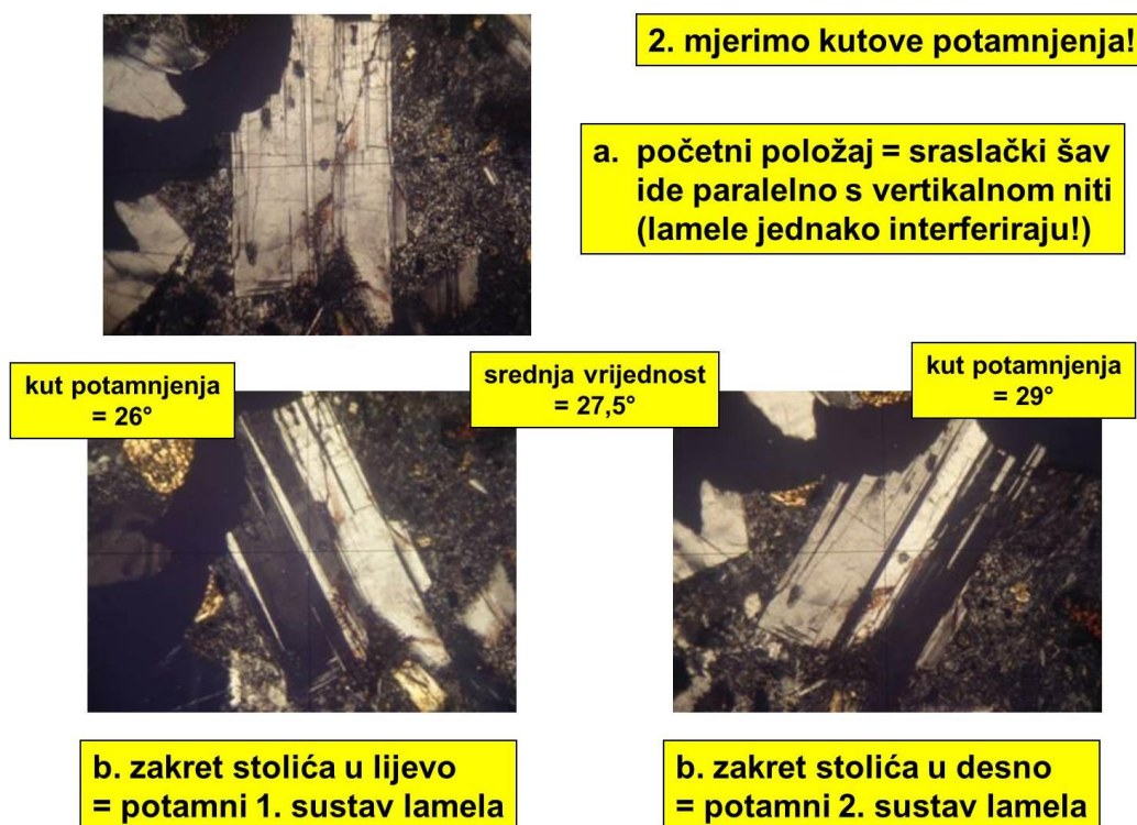
Slika 7.5.16. Primjer određivanja karakterističnog kuta kosog potamnjenja na presjeku koje se nalazi u zoni simetrijskog potamnjenja.
