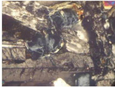
Slika 7.6.10. Različiti presjeci klorita (u središtu vidnog polja). Bez analizatora se uočava nizak reljef i blaga zelenkasta boja, a s analizatorom karakteristična interferencijska siva boja 1. reda.
